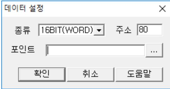
**종류 :** 데이터 종류를 설정한다. 16BIT(WORD), 32BIT(FLOAT), 32BIT(DWORD)등이 있다. 일반적으로 디지털 데이터는(영역 1, 10) 16BIT(WORD)로 설정하고, 아날로그 데이터(영역 30, 40)는 32BIT(FLOAT)로 설정한다.
