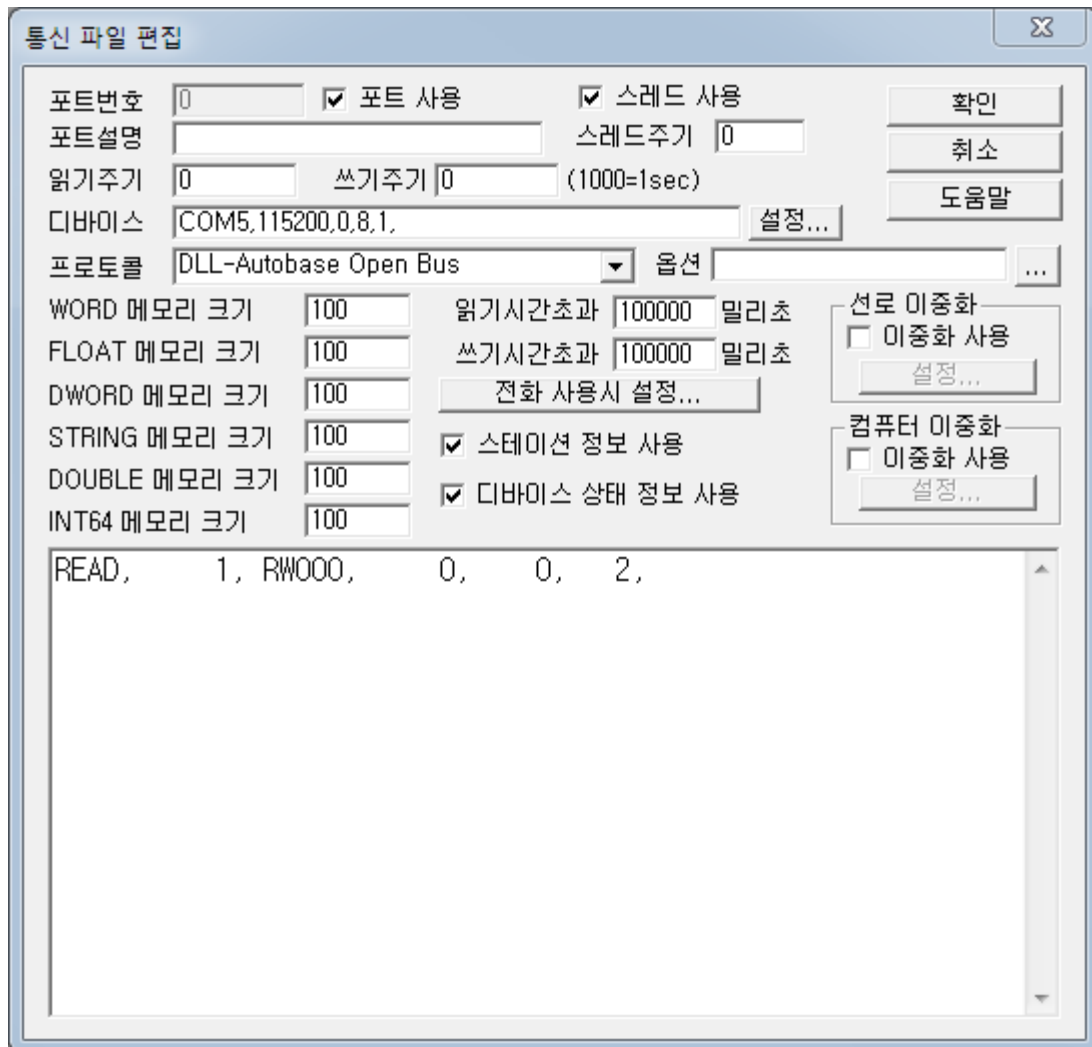
<그림 4-5> Autobase I/O Controller와 AOB 프로토콜을 통신시키기 위한 Autobase 통신 설정 예제
